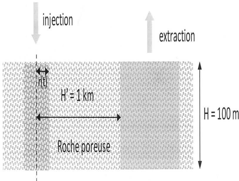
L'eau à  $70^\circ\text{C}$  est pompée vers la surface, et après utilisation elle est réinjectée pour maintenir la pression en amont (schéma simpliste ci-contre) Elle a alors une température de  $10^\circ\text{C}$ . La distance entre les puits d'injection et de réinjection est d'environ  $H' = 1 \text{ km}$ .
