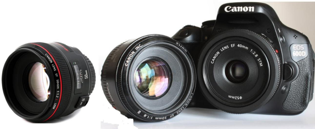
L'objectif EF 50 mm 1:1.2 L USM (à gauche) possède une motorisation ultrasonique (UltraSonic Motor). Le modèle EF 50 mm 1:1.8 II (au milieu) quant à lui possède une motorisation classique avec un micro-moteur à courant continu. Enfin, le modèle EF 40 mm 1:2.8 STM (à droite) possède une motorisation pas à pas (Stepper Technology Motor) et est monté sur cette image sur un appareil EOS 600D.
